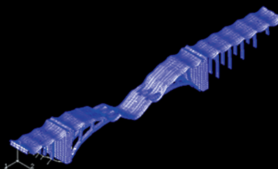
"Simulación del desplazamiento del Viaducto 1 Caracas-La Guaira" Genny Roa, Ingeniería computacional, ULA, abril 2005
