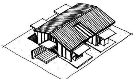
**Figura 3.** Vista general del prototipo de vivienda industrializada, transportable y plegable con techo de teja de arcilla criolla.
