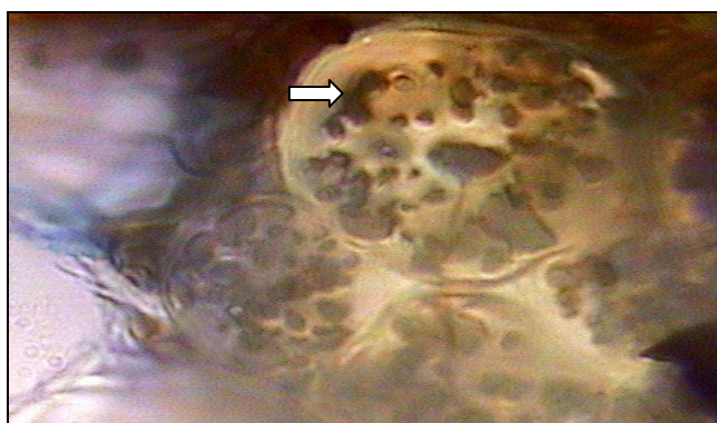
Figura 12. Madera de Ceiba Roja sin Tratamiento, Testigo, mostrando Abundante Presencia de Cavidades, Patrón de Degradación Conocido como Pudrición Blanda Tipo I.
