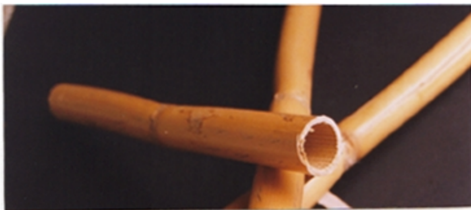
FIGURA 2. Sección de Caña brava cercana al ápice del tallo, donde se aprecia la ausencia de la zona parenquimatosa, dejando hueco el interior del tallo.
