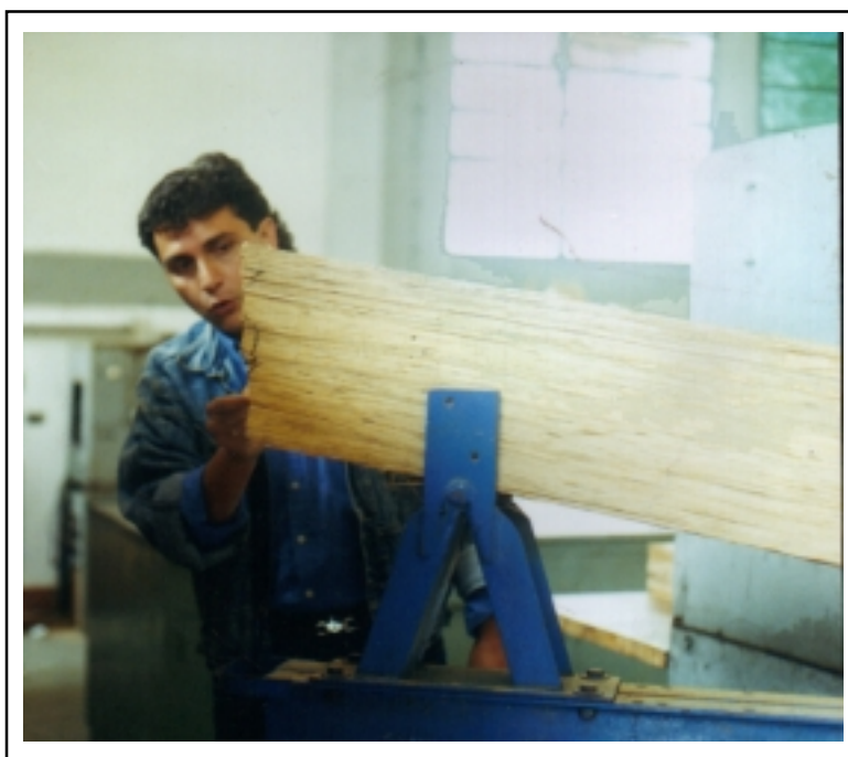
FIGURA 4. Falla en bloques de los extremos de la viga laminada
