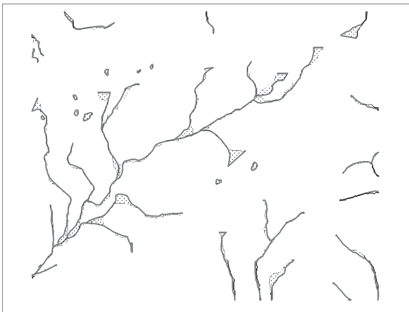
Figura 7. Comparación visual de la red hidrográfica generada (negra delgada) con la digitalizada del mapa original (gris gruesa) a partir de un MDE a escala 1:25.000, equidistancia 40 m y tamaño de píxel 30 m
