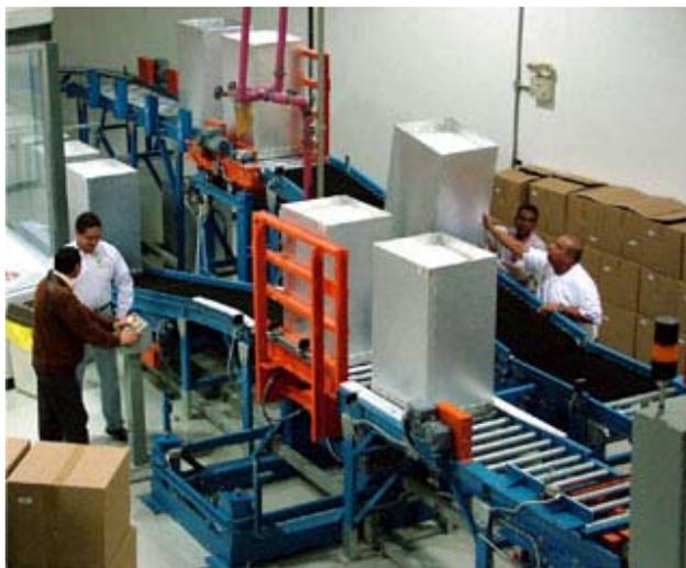
Planta Pegamma, preparación de los materiales a irradiar en la línea de montaje
