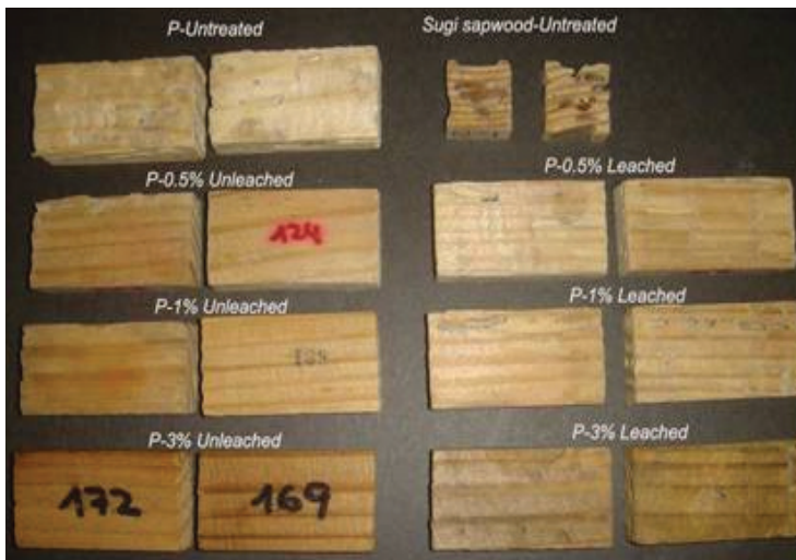
Figura 3. Estado de probetas de pino del ensayo de resistencia a termitas luego de tres semanas (p: pino).
