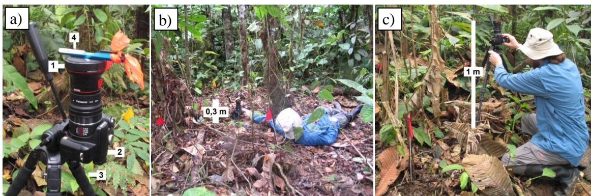
Figura 13. Equipo empleado (a) en la toma de las fotografías hemisféricas a 0,3 m (b) y 1 m (b) de altura. 1 = lente hemisférico, 2 = cámara, 3 = trípode, 4 nivel.
