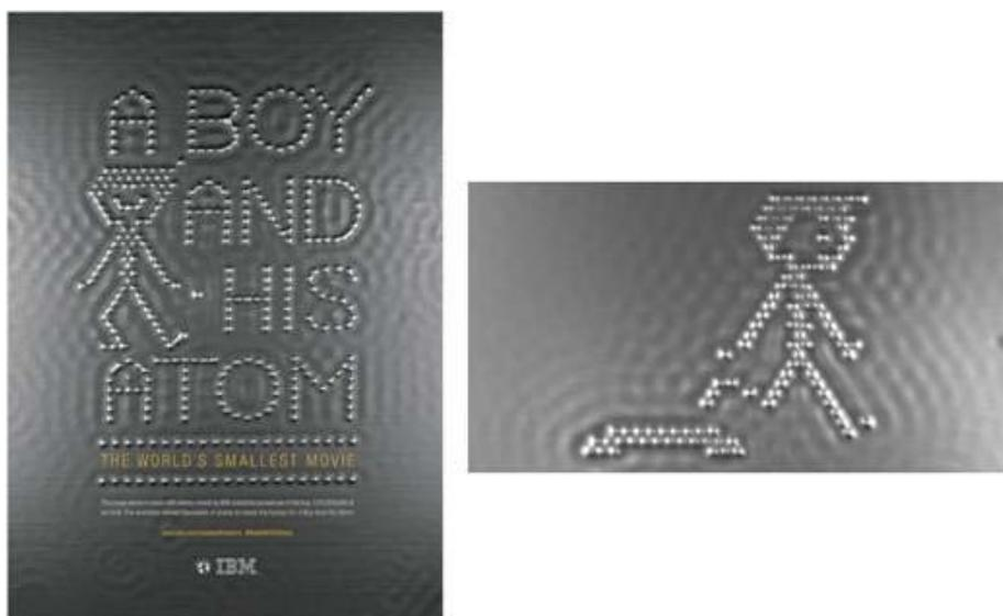
**Fig. 1.19:** Imagen de la película más pequeña del mundo: “Un muchacho y su átomo” desarrollada por científicos de *IBM* con un microscopio de efecto túnel que permitió manipular un grupo de átomos de carbono sobre una superficie de cobre metálico. Récord Guinness en 2013 como “la película más pequeña en *stop-motion*” (créditos: *IBM Research*).
