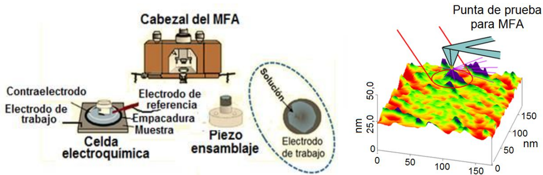
Fig. 4.7: Arreglo esquemático para la microscopía de fuerza atómica acoplada al sistema electroquímico.
