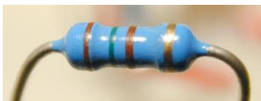
Figura 10: Resistencia de carbón comercial de 150 ohmios.
