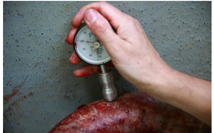
FIGURA 5: Midiendo la dureza superficial en la pala
