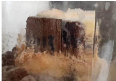
Figura 17. Crecimiento miceliar de G. trabeum sobre A. mangium , en probeta sin preservar en el tercer mes de incubación
