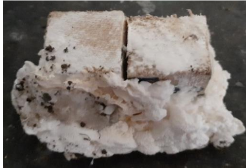
Figura 25. Crecimiento micelial de T. versicolor sobre S. amara , en probeta sin preservar en el tercer mes de incubación
