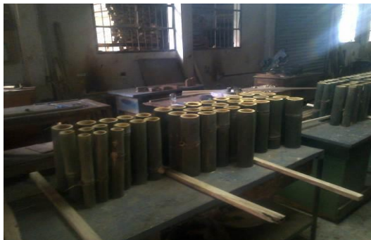
Figura 5. Probetas para la preservación química
