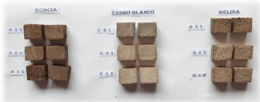
Figura 9. Penetración del preservante ACQ al 1 %, 2 % y 3 % en las maderas de acacia ( A. mangium ), cedro blanco ( S. amara ) y melina ( G. arborea )
