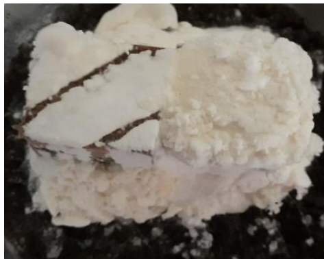
Figura 20. Crecimiento micelial de T. versicolor sobre A. mangium , en probeta sin preservar del tercer mes de incubación
