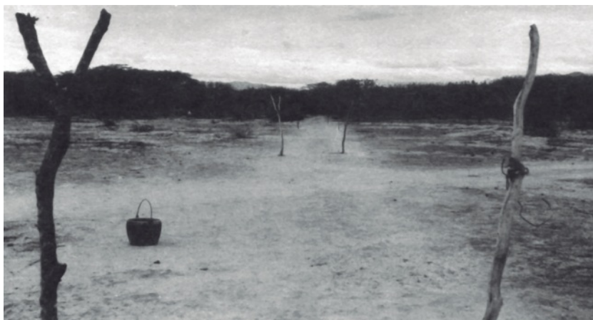
Foto 15: Urdidero de un tejedor de cocuiza, mostrando las estacas donde se extiende el hilo para enrollarlo luego en forma de pelotas. Morón, estado Lara.
