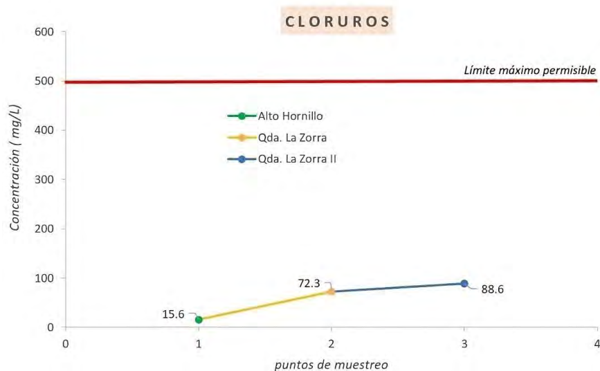
FIGURA 4. Contenido de cloruros. Fuente: elaboración
