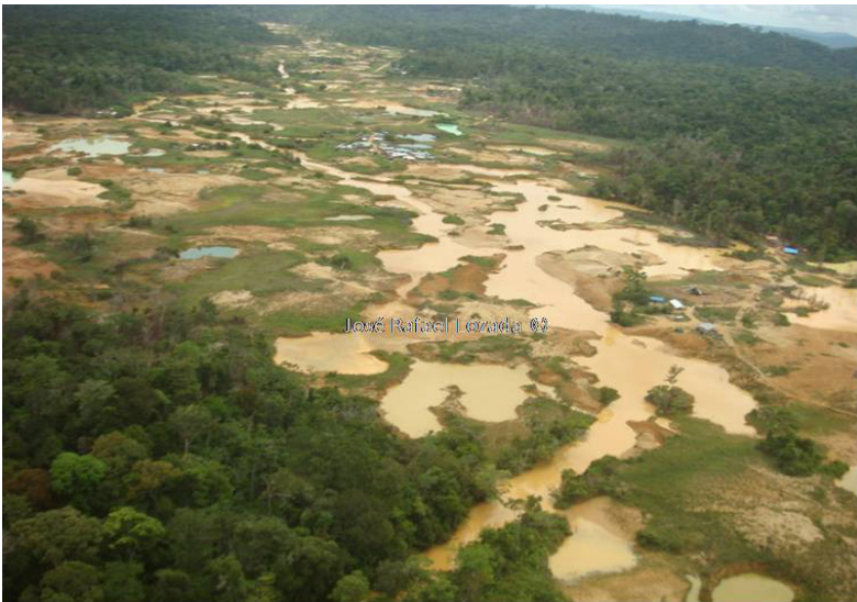
Figura 6 'Huecos' resultantes de la minería de monitor hidráulico
