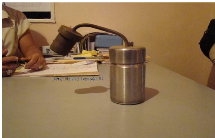
Figura 20 'Retorta' diseñada para evitar la fuga de gases de mercurio
