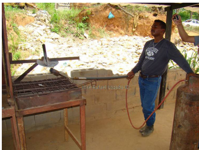
Figura 5 'Resumen' (evaporación del mercurio por aplicación de calor)
