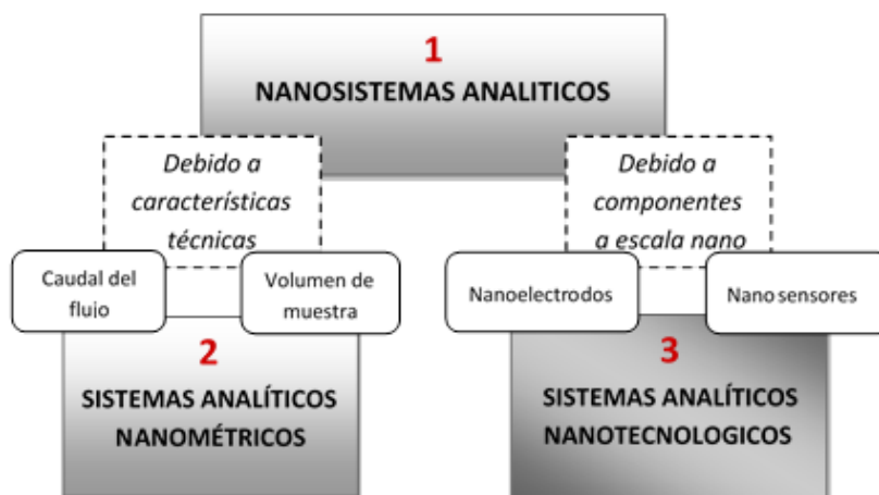
Fig. 2.1: Los tres diferentes escenarios para los nanosistemas analíticos: (1) escenario ideal, (2) sistemas analíticos con dimensiones nanométricas, (3) sistemas analíticos nanotecnológicos.
