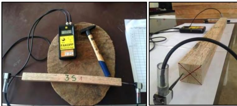
Fig. 1. Equipo Microsecond Timer y Sensores del equipo
